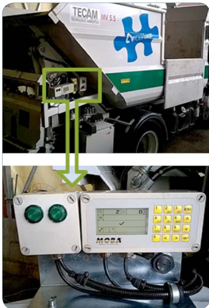
Figura 2 | Sistema tecnologico a bordo mezzo per la lettura automatica dei sacchi Rfid.
