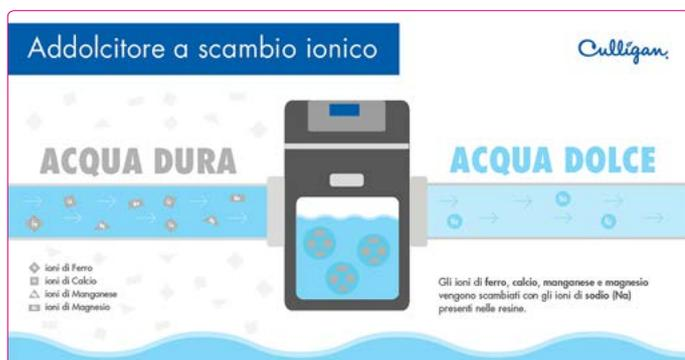
Figura 1 | Principio dello scambio ionico in un addolcitore.
