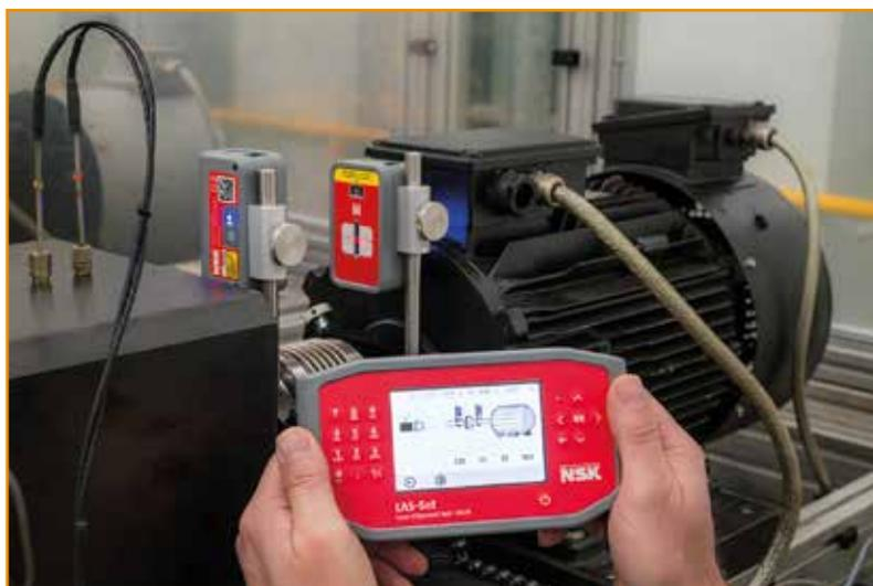
**Figura 1 – LAS-Set di NSK utilizza due fasci laser per facilitare la regolazione anche su lunghe distanze.**
