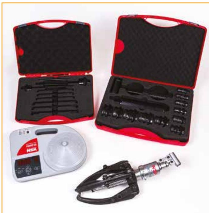
**Figura 3 – Alcuni utensili compresi nel pacchetto per la cura dei cuscinetti proposto dal programma a valore aggiunto AIP+ di NSK.**
