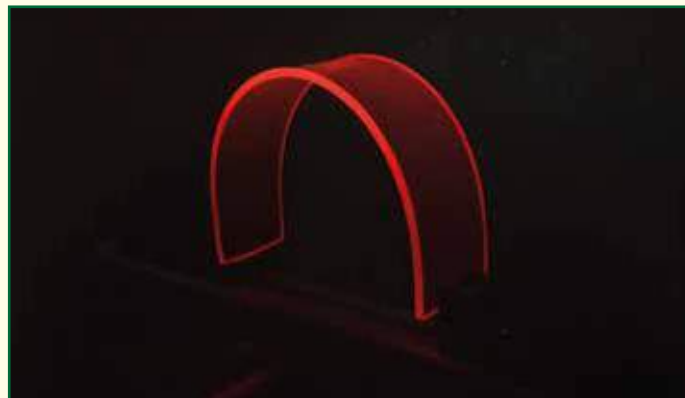
Figura 2 – Gli LSC possono assumere qualsiasi forma per essere integrati nei più svariati elementi architettonici.
